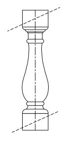
RAKED BALUSTRADE IS AVAILABLE IN VARIOUS PATTERNS. AN EXTENSION BLOCK IS PROVIDED FOR CUTTING ANGLE ON SITE.
